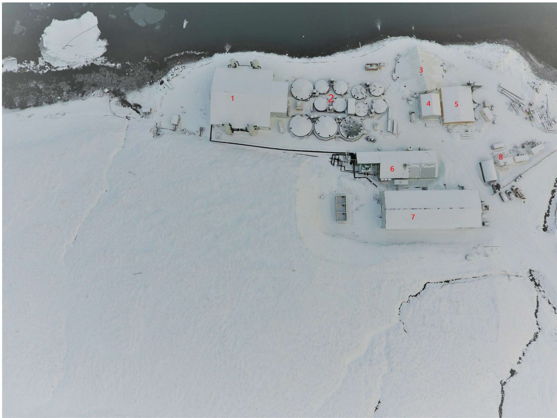
Mynd 2.1. Yfirlitsmynd af eldisstöðinni, tekin úr dróna í febrúar 2022. Númeruð mannvirki og reitir eru: 1. Smolt hús. 2. C-D útiker. 3. Gamalt ker sem er safntankur frá tromlusíum, nefnt C1. 4. Nýtt endurnýtingarhús. 5. Geymsla fyrir rör og slöngur o.fl. 6. Græna húsið, geymsla, vararafstöðvar og súrefnisdæling. 7. Startfóðrun, skrifstofa og kaffistofa. 8 Geymsla fyrir fóður og tæki.
