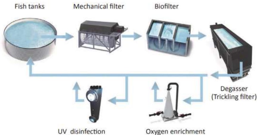
Mynd 2.2. Dæmi um hvernig endurnýtingarkerfi líkt og sett verður upp á Gileyri virkar. Vatn fer úr eldistanki í gegnum tromlusíu og þaðan í lífræna síu. Vatnið er svo afgasað áður en súrefnisinnihald þess er aukið og það leitt í gegnum útfjólubláan filter til sótthreinsunar. Myndin tekin af https://www.fao.org/3/i4626e/i4626e.pdf
